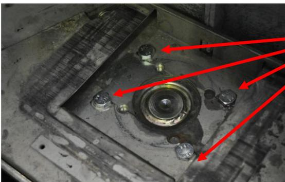
5. 4 neue Befestigungspunkte bohren.
