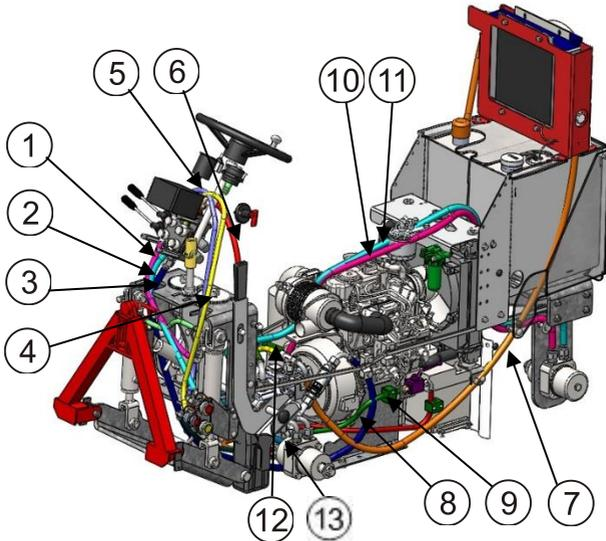
Abb. 28 - Hydraulikleitungen
