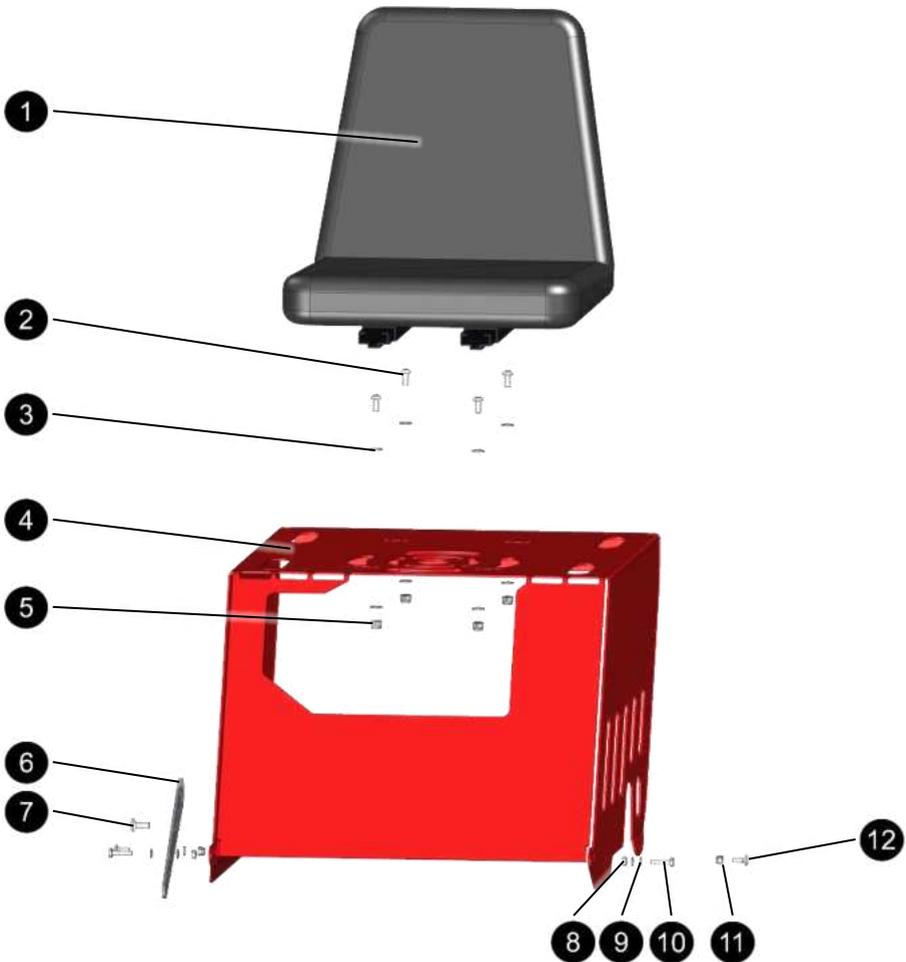
Abb. 53: Ersatzteile Motorhaube
