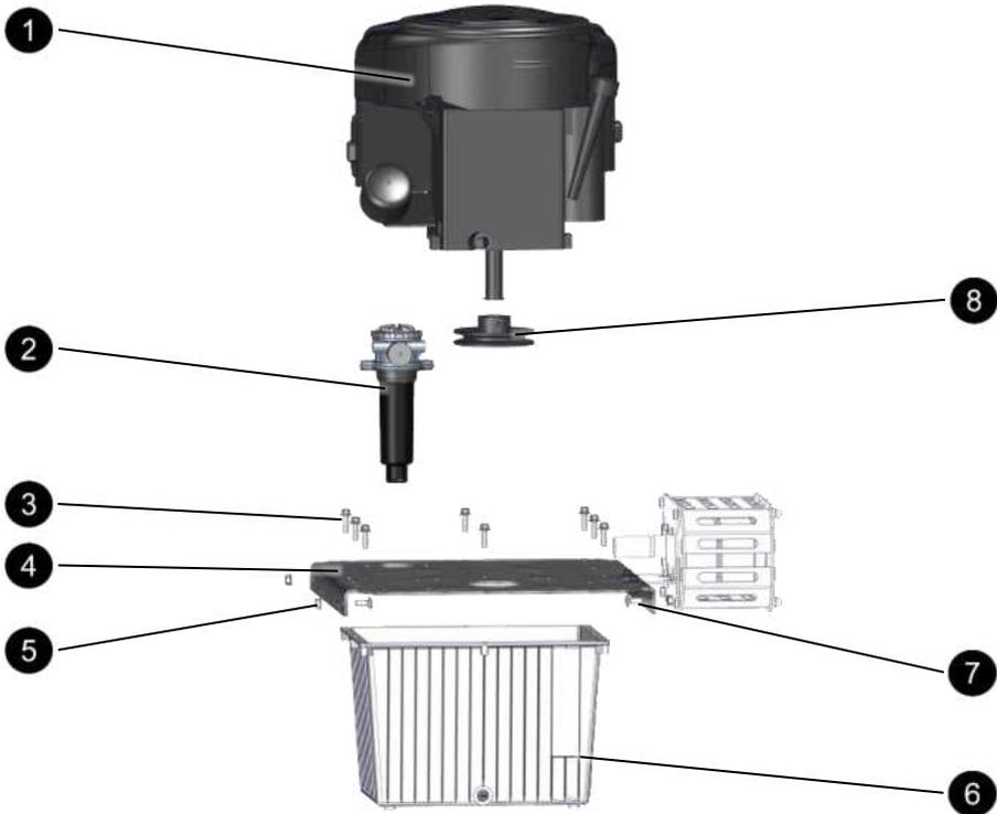
Abb. 46: Ersatzteile Motor mit Ölwanne
