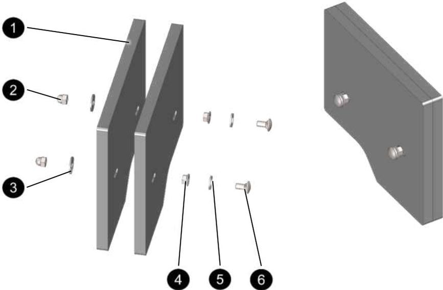
Abb. 57: Ersatzteile seitliche Heckgewichte
