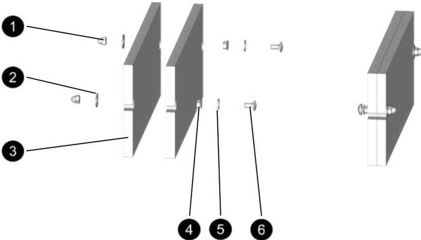
Abb. 56: Ersatzteile seitliche Zusatzgewichte
