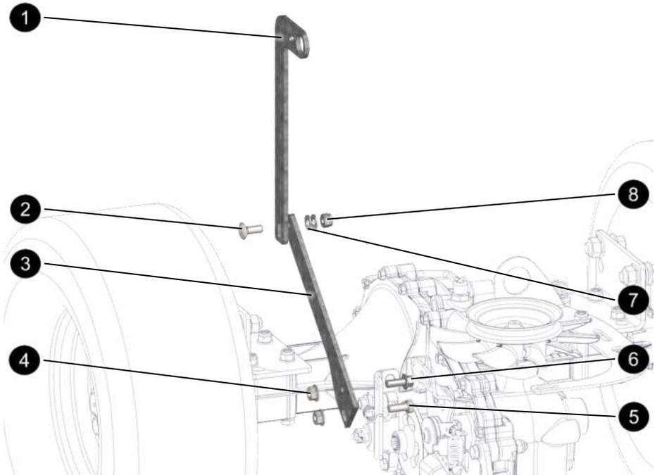
Abb. 42: Ersatzteile Feststellbremse
