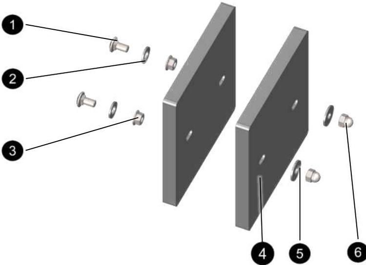
Abb. 58: Ersatzteile mittige Heckgewichte
