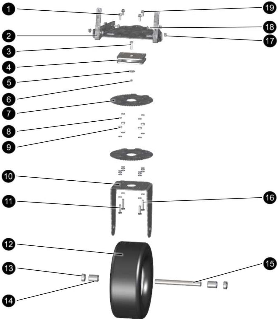
Abb. 48: Ersatzteile Hinterachse
