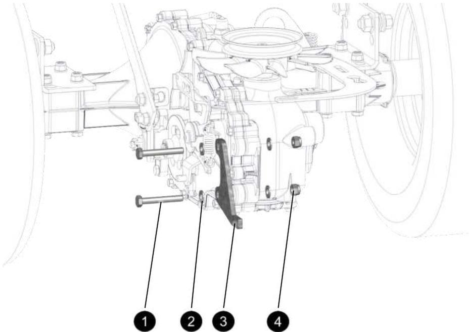
Abb. 43: Ersatzteile Drehmomentstütze
