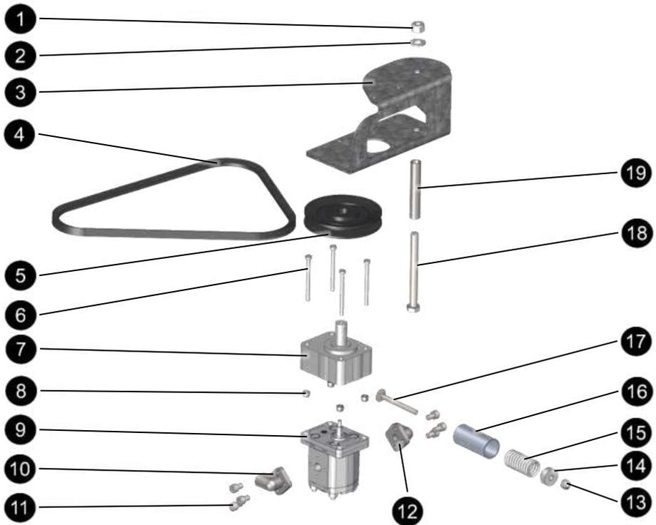
Abb. 52: Ersatzteile Halter Hydraulikpumpe
