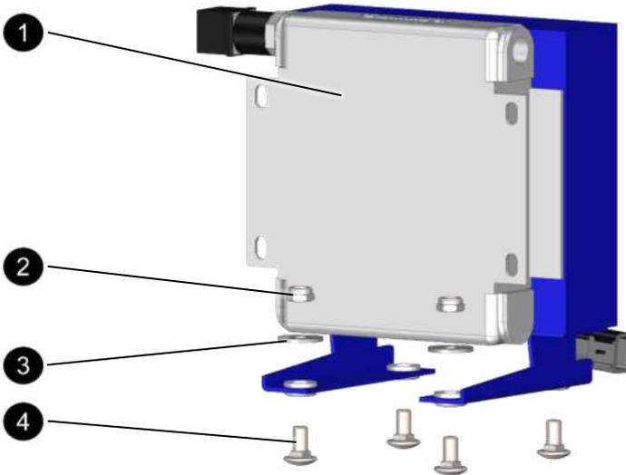
Abb. 59: Ersatzteile Zusatzölkühler
