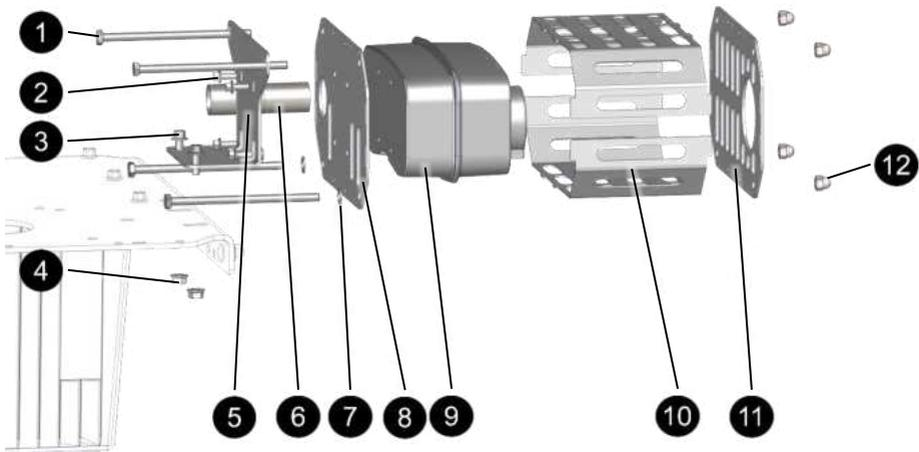
Abb. 47: Ersatzteile Auspuff
