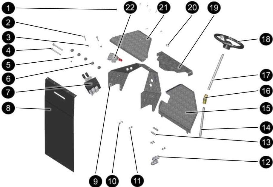
Abb. 51: Ersatzteile Lenkkonsole
