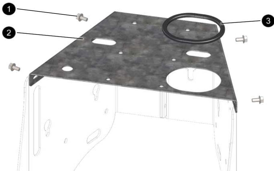
Abb. 34: Ersatzteile Deckel
