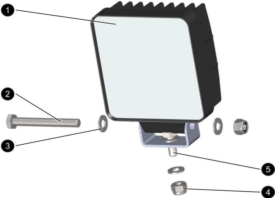
Abb. 55: Ersatzteile Arbeitsscheinwerfer
