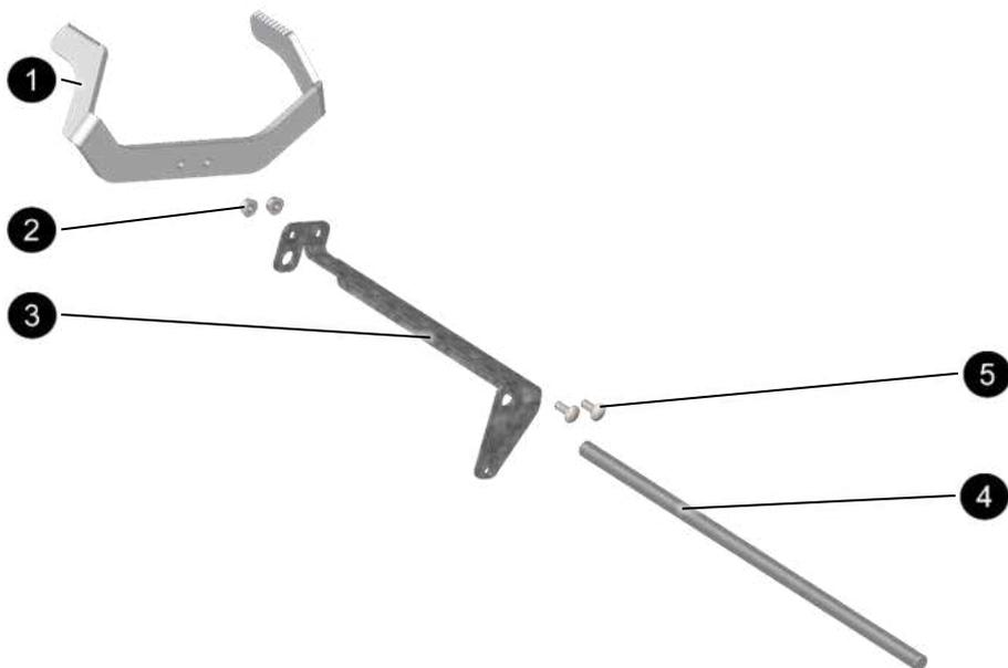
Abb. 50: Ersatzteile Fahrpedal
